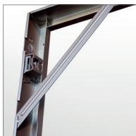
Premarco de acero electrocincado de 2,2 mm de espesor, con ingletes soldados, garras atornilladas y marca a 1 m del suelo.
