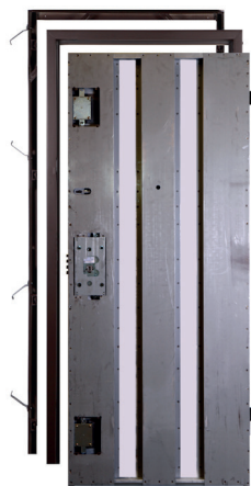
Estructura de la hoja , en acero electrocincado formada por 3 omegas de refuerzo vertical.
